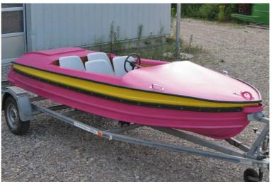
Alle Boote mit seitliche Auftriebskörpern, Innenverkleidung aus Bootsbausperrholz. Rammschutzbügel im Burg, Scheuerleisten aus gleitfähigem HD-PE Kunststoff. Im Bug zwei seitliche Tragegriffe, großer Buggriff
