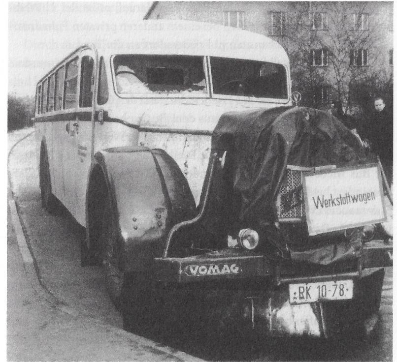
*Hans Weidners Bus: Fahrgastraum und Räder hatte er mit Stahlplatten gepanzert, unter der Stoßstange war ein Schneepflug montiert.*
