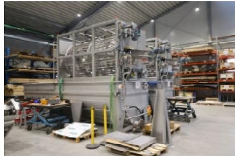
Abscheideanlagen von Schleifstaub, der bei der Produktion von Schiern anfällt.
