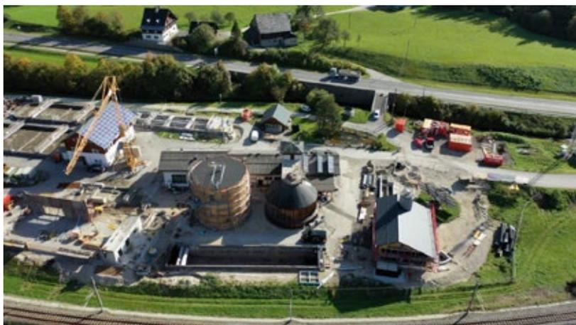
Neben diversen Anpassungsmaßnahmen werden ein neues 2-straßiges Rechenhaus, ein zweiter Faulturm mit integriertem Gasspeicher, ein Tripple-A-Becken anstelle des VKB und eine große Lagerhalle errichtet. Im Rahmen dieser Arbeiten wird auch der Standort der Kläranlage im Hinblick auf die Blackout-Thematik bzw. Großstrommanagellagen vorbereitet.
