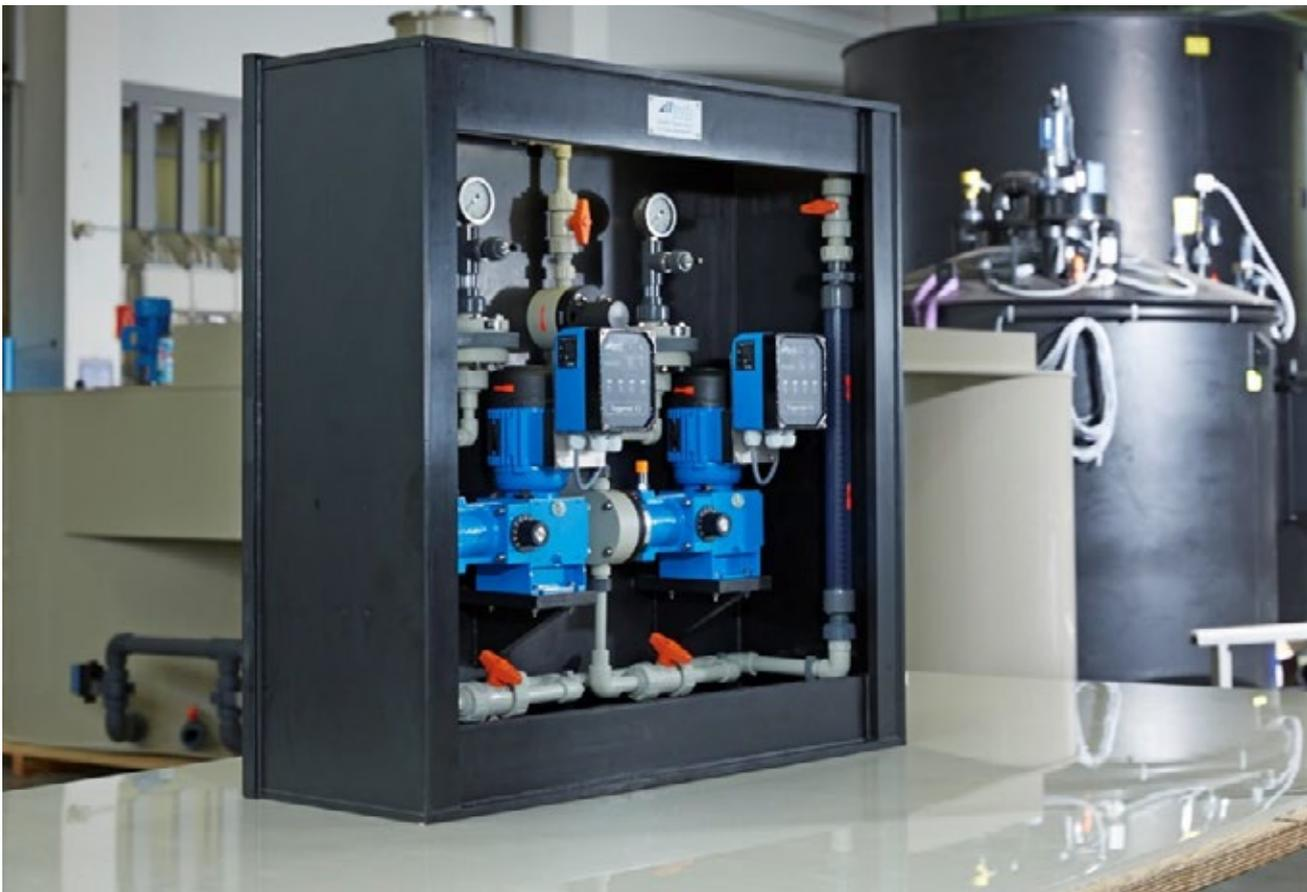
*Bild: Beispiel für ein Eisen-III-Chlorid Dosiersystem*
