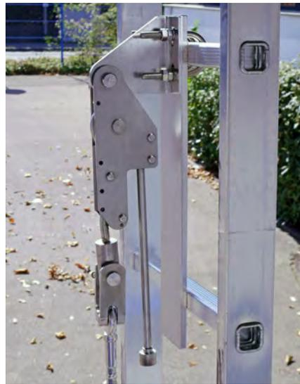
Systemfalldämpfer am oberen Befestigungspunkt
