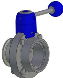
Scheibenventil CG einseitig Clampstutzen DIN 32676 – einseitig Gewinde DIN 11851
