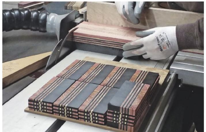
*/ Hohe Ausbeute: Mittels eines nur 2 mm starken, mit Diamant bestückten Sägeblattes werden die aufwendig verleimten Blöcke möglichst verlustfrei aufgesägt.*
