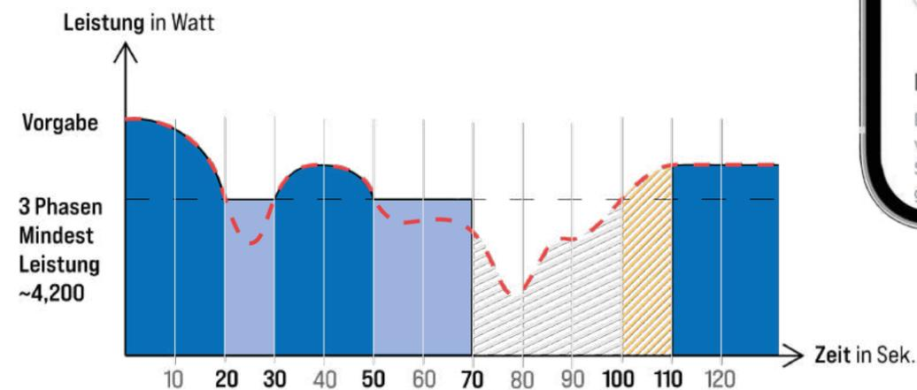
■ wird geladen   ■ wird mit Mindestleistung geladen/ Ausschaltverzögerung   ▨ wird nicht geladen
