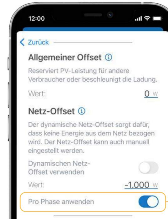
Zusätzlich kannst du definieren, ob der Grid Offset pro aktiver Ladephase angewandt wird. Besonders sinnvoll für die Phasenumschaltung, weil sich die Anzahl zur Laufzeit ändert.
