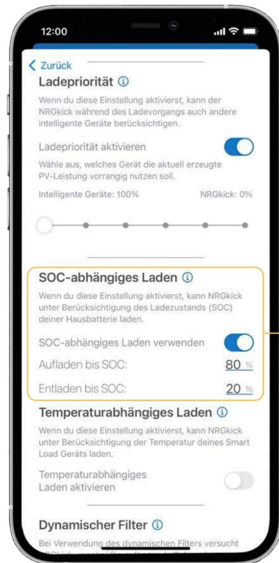
» **SOC (State of Charge) abhängiges Laden:** Bei dieser Einstellung kannst du bei Bedarf eine Ladezustandsgrenze der Hausbatterie definieren. Nach Überschreitung dieser Grenze wird die Ladeleistung der Hausbatterie entzogen und an den NRGkick umgeleitet.
