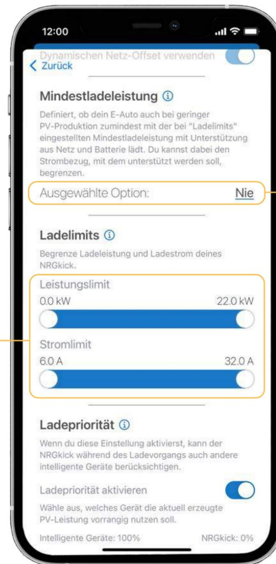
» **Nie:** Sobald die PV-Leistung die Mindestladeleistung überschreitet, wird die Ladung gestartet. Der Ladevorgang wird schnellstmöglich beendet, wenn nicht genügend PV-Leistung zum Laden des Fahrzeugs produziert wird.
