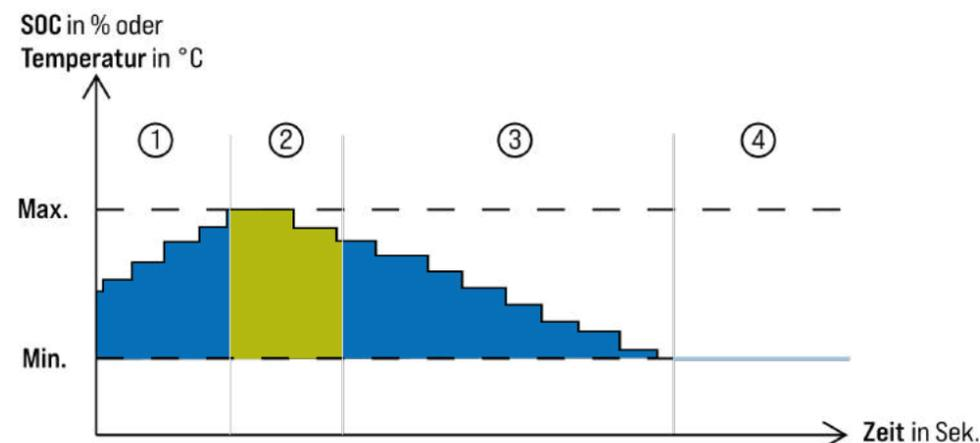
» **Temperatur abhängiges Laden:** Bei dieser Einstellung kannst du bei Bedarf eine Temperatur Obergrenze der intelligenten Geräte definieren. Nach Überschreitung dieser Grenze wird die Ladeleistung der intelligenten Geräte entzogen und an den NRGkick umgeleitet.
