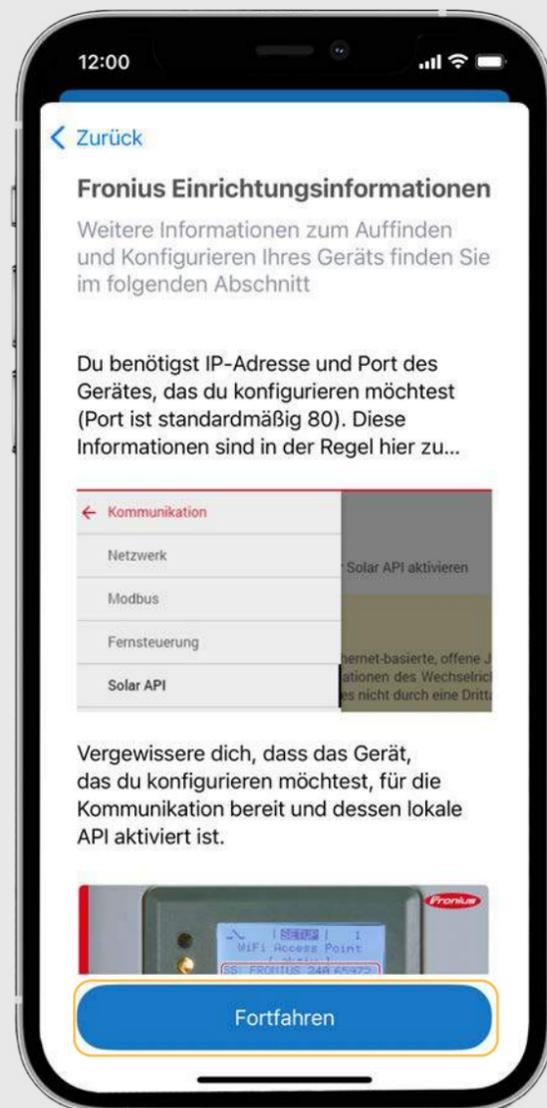
1.6. Anschließend kannst du dir die Einrichtungsinformationen durchlesen und auf „PV Laden konfigurieren“ tippen.
