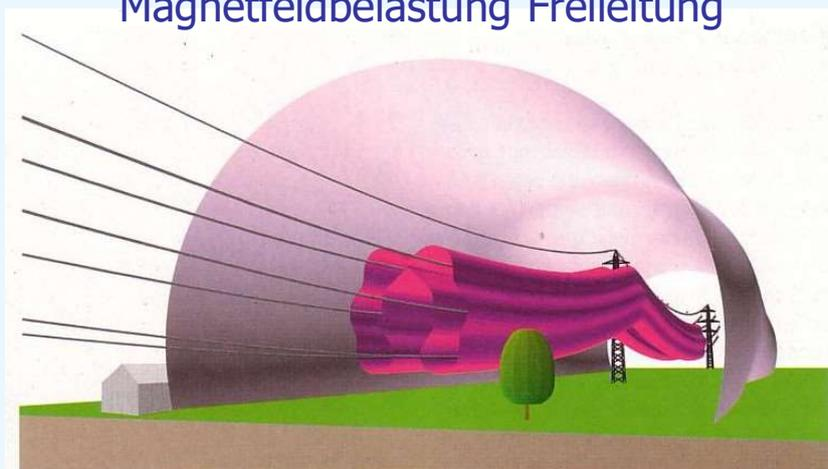
Perspektivische Darstellung des Magnetfeldes einer typischen 380-kV-Hochspannungsleitung mit zwei Strängen bei Vollast (1920 A). Im Umkreis der sechs Strom führenden Leiterseile tritt die stärkste Belastung auf. Sie beträgt innerhalb der roten Schläuche mehr als 100 Mikrottesla ( $\mu\text{T}$ ) und bei der Hülle des grossen Tunnels noch 1  $\mu\text{T}$ .
