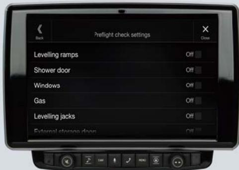
Viele Schäden an Reisemobilen entstehen nach einem Aufenthalt am Stellplatz unmittelbar bei Fahrtantritt. Der Alpine "Pre-Flight Check" (Abfahrtskontrolle) erinnert Sie nochmal daran, jetzt alle sicherheitsrelevanten Punkte wie z. B. Gas abgestellt, Fenster und Türen gesichert, Satellitenantenne eingefahren, Unterfahrkeile entfernt usw., zu prüfen.
