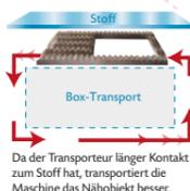
Da der Transporteur länger Kontakt zum Stoff hat, transportiert die Maschine das Nähobjekt besser.
