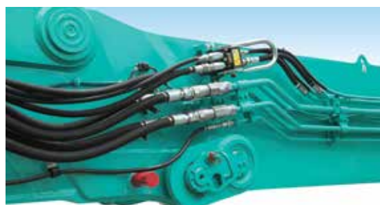
Leitungsanschluss: Multi-Kupplungssystem an der Auslegerseite.
