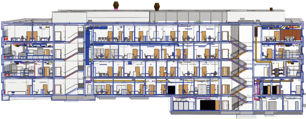
Die Bauplanung wurde bereits in einem höchst digitalisierten Umfeld durchgeführt, und zwar mithilfe von Building Information Modeling (BIM). Diese fortschrittliche Planungsmethode ermöglichte es, sämtliche Gewerke in einem Modell zusammenzuführen und technische Aspekte bis ins kleinste Detail zu erfassen. Durch BIM konnte allen Bauteilen Funktionen zugewiesen und präzise Daten zugeordnet werden.
