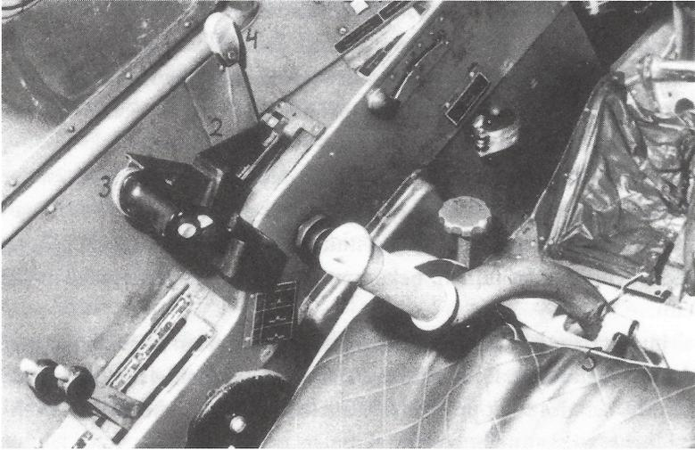
*Mit dem sogenannten Waffeisen (2) konnte der Gashebel (3) des Agrarflugzeugs blockiert werden. Der Steuerknüppel wurde mit einem Schloss am Pilotensitz gesichert.*
