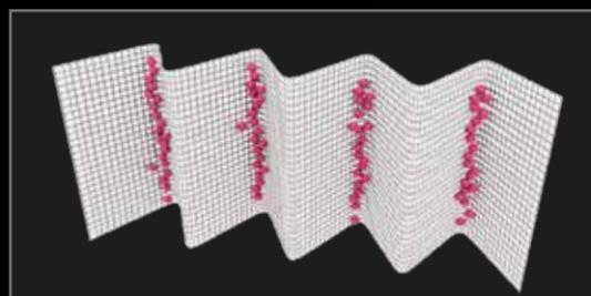
Der iNDr-Filter verfügt zum Auffangen von Staub über ein hochdichtes Netz von 30 Linien pro Zoll.
