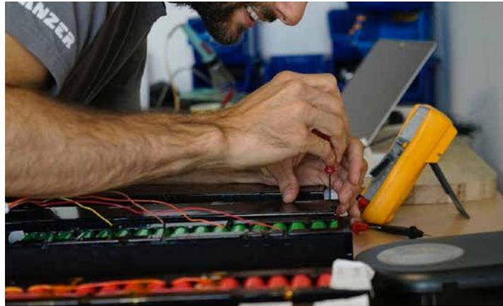
Aufbereitung von Batterien bei upVolt: Reparieren statt entsorgen. (Bild: zVg)
