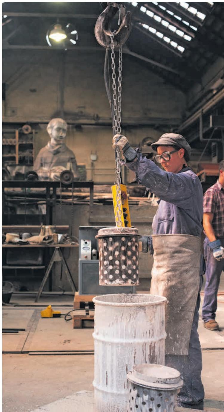
In der Giesserei wird eine Kivette zum Abkühlen ins Wasserbad getaucht. Inhalt: ein Basiliskenkopf, zirka 650 Grad heiss.
