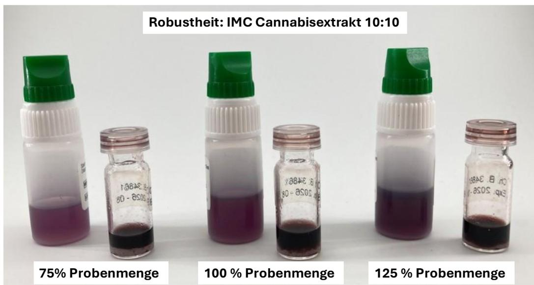
Abbildung 3: Fotos nach Durchführung des CannaFix-ID THC/CBD Schnelltest-Sets mit dem IMC Cannabisextrakt 10:10 (Probenvolumen: 75 µl, 100 µl und 125 µl).
