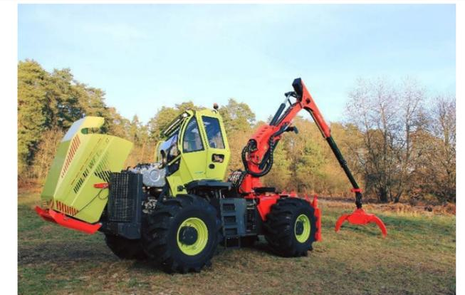
CAPOT MOTEUR, PROTECTION FRONTALE, RÉSERVOIR HYDRAULIQUE ET CABINE À BASCULEMENT HYDRAULIQUE
