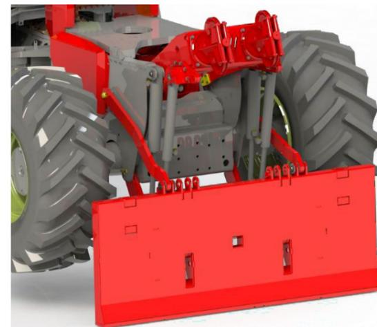
DOUBLE TREUIL À TAMBOUR JUSQU'À 10 TONNES DE FORCE DE TRACTION
