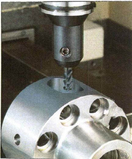
Bild 2.23: Insbesondere beim Schlichtfräsen von zähen, langspanenden Stählen (s. Bild 2.25) überzeugen Cermetfräser durch hohe Zerspanungsleistungen.
