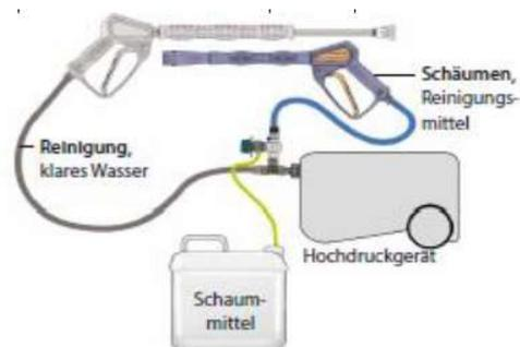
Zur Installation zwischen einem Hochdruck-Gerät und dem original HD-Schlauch.
