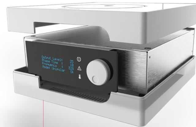
Vollständig abgeschirmte Elektronik zur Vermeidung von Antenneneffekten
