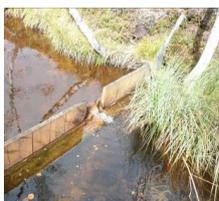
Aus diesem Grund wurde die Messung mit einem V-Wehr – 90° durchgeführt. Das V-Wehr wurde an jener Stelle eingebaut, wo der größte sichtbare Abfluss im Wasenmoos stattfindet. Nach mehreren Versuchen wurden die Messungen auf ein Wehr beschränkt, da beim Abfluss erkennbar ist, dass offensichtlich ein Teil wieder in einen unterirdischen Begleitstrom des entwässernden Baches Richtung Osten verschwindet.
