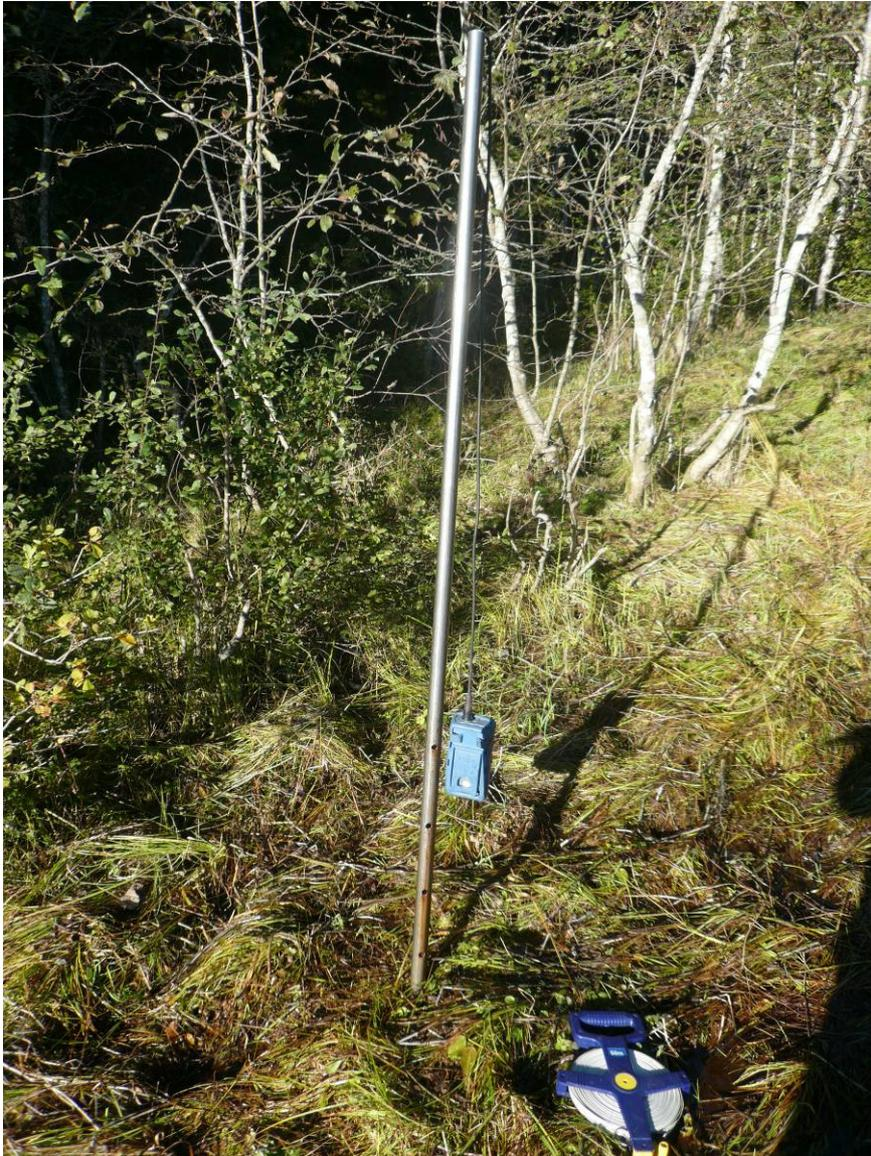
*Abbildung 18: Messrohr 2m mit Leitfähigkeitsmessgerät*
