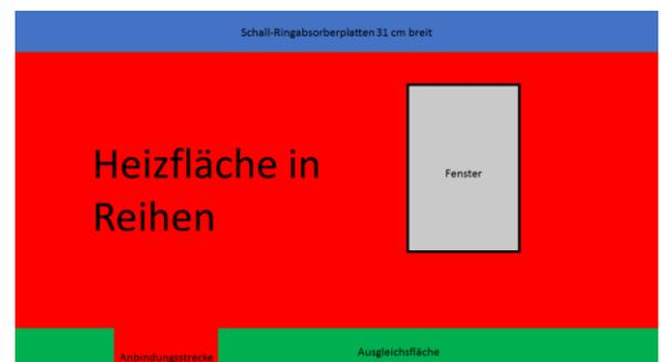
Maximale Heizleistung mit Schallabsorber
