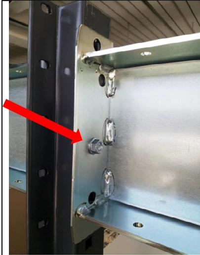
Verschrauben Sie den oberen Querträger mit je einer Schlossschraube M8 x 70 und der passenden Ripp-Mutter an beiden Ständern.
