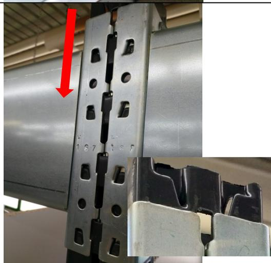
Hängen Sie den oberen Querträger bei beiden Ständern ein. Montage mittels Gummihammer, bis die Traverse komplett eingehängt ist.
