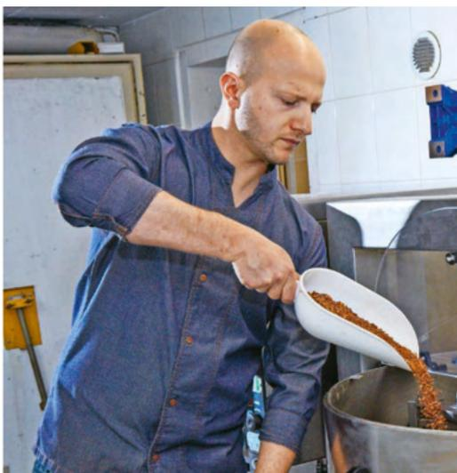
Die gerösteten Kakaobohnen werden zerkleinert und im Melangeur verflüssigt. Ein Prozess, der bis zu drei Tage dauern kann.
