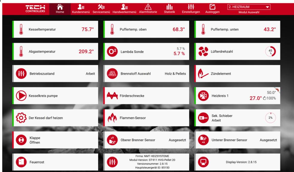
Werden alle Funktionen ordnungsgemäß und analog zum Kessel-Display angezeigt ist die Registrierung und Inbetriebnahme abgeschlossen.
