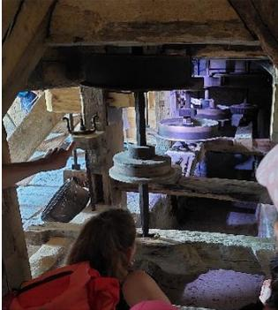
Herr Pick hat uns zuerst zur großen Mühle gebracht, diese stand an einem kleinen Fluss. Dort haben wir viele verschiedene Geräte gesehen. Ein Gerät musste man drehen, dann wurden die Spelzen der Körner entfernt. Das große Mahlwerk der Mühle wurde durch Wasser angetrieben.
