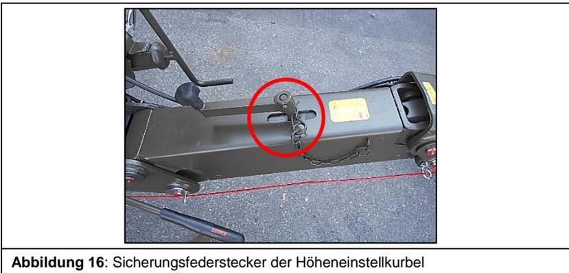
Abbildung 16: Sicherungsfederstecker der Höheneinstellkurbel
