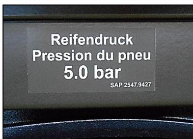
Pos. 12: Aufkleber Reifendruck (2, Kotflügel)
