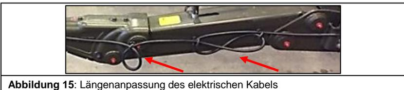
**Abbildung 15:** Längen Anpassung des elektrischen Kabels
