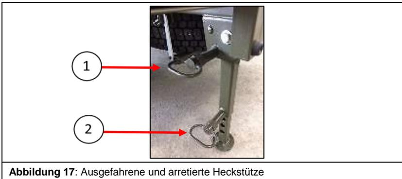
**Abbildung 17:** Ausgefahrene und arretierte Heckstütze
