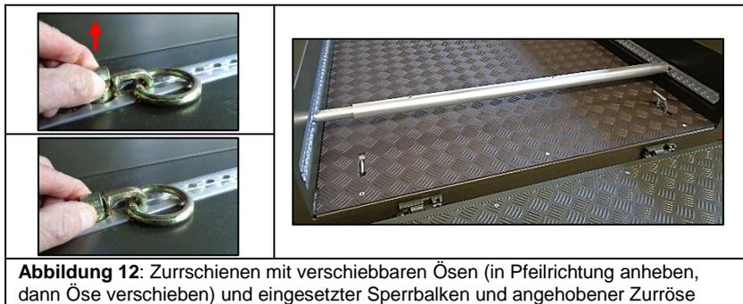
**Abbildung 12:** Zurrsschienen mit verschiebbaren Ösen (in Pfeilrichtung anheben, dann Öse verschieben) und eingesetzter Sperrbalken und angehobener Zurröse
