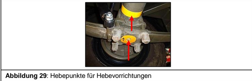
**Abbildung 29:** Hebepunkte für Hebevorrichtungen
