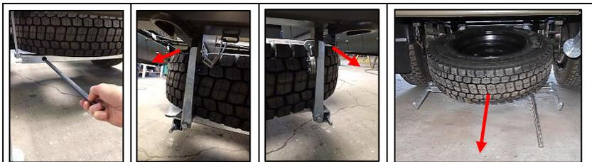
**Abbildung 28:** Ersatzrad mit Ersatzradhalter und Hebel
