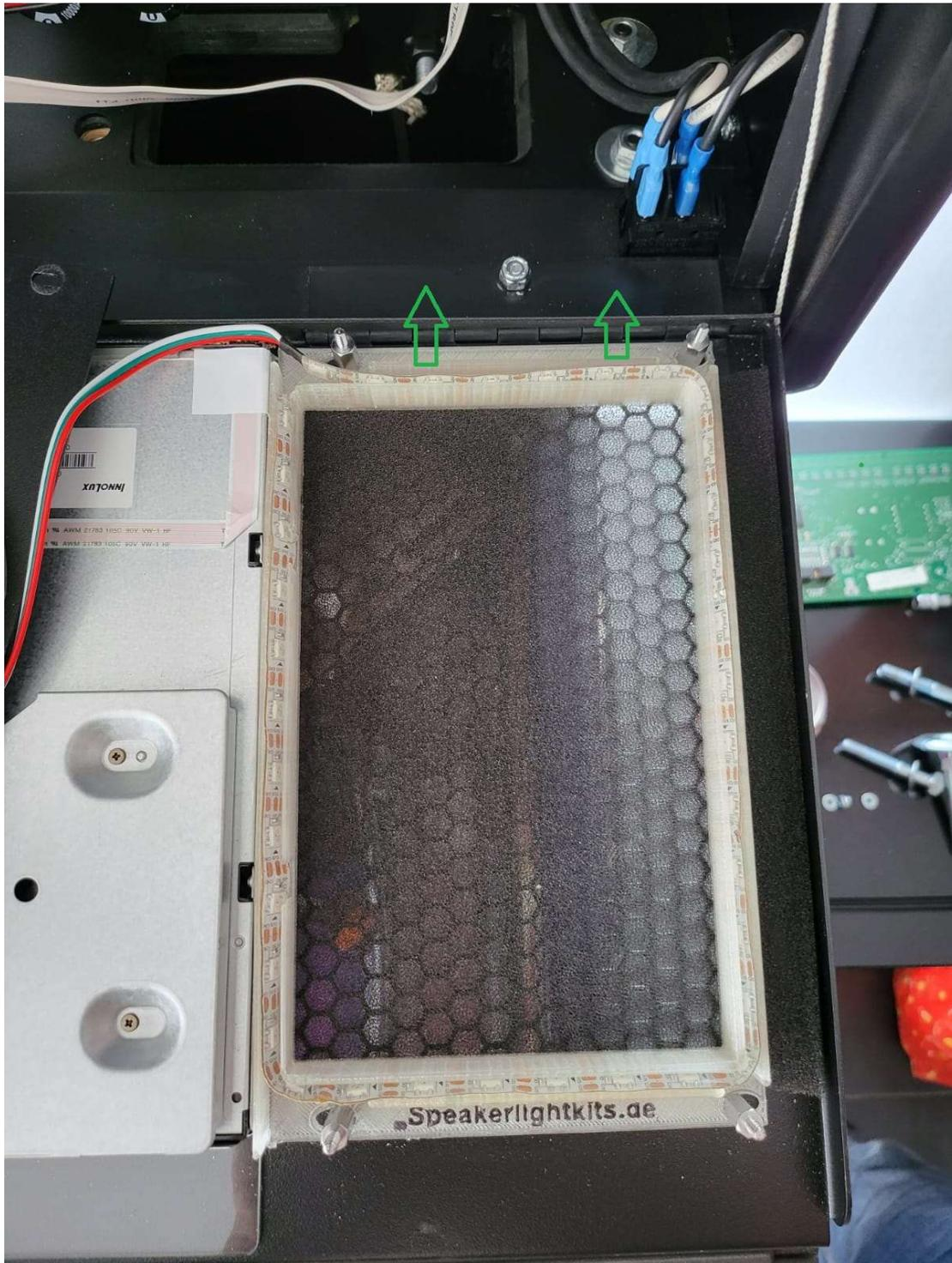
Die Speakerlightkits auf die Stehbolzen stecken, und mit den Distanzstücken vorsichtig festschrauben. Die Öffnung mit den Kabeln muss nach unten und innen zeigen.
