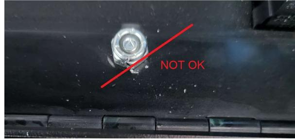
Die Position der Mutter in der Backbox prüfen und ggf leicht verdrehen, da bei verdrehter Mutter sich die Klappe nicht richtig schließen lässt.
