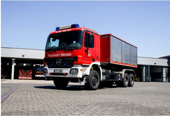
**Wechselladerfahrzeug mit Abrollbehälter Gefahrgut**
