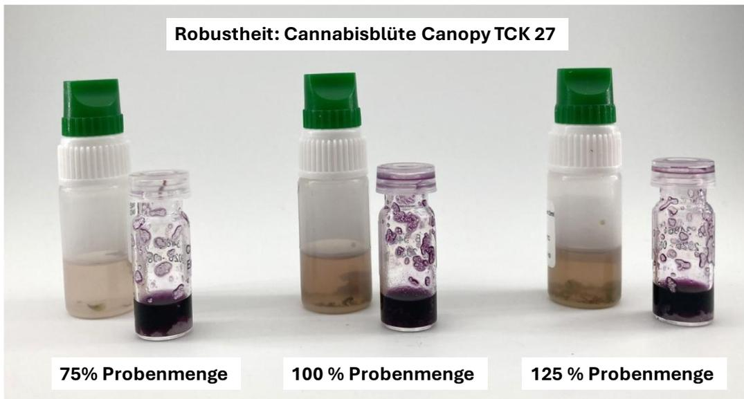
Abbildung 3: Fotos nach Durchführung des CannaFix-ID THC/CBD Schnelltest-Sets mit der Cannabisblüte Canopy TCK 27 (Probenvolumen: 15 mg, 20 mg und 25 mg).
