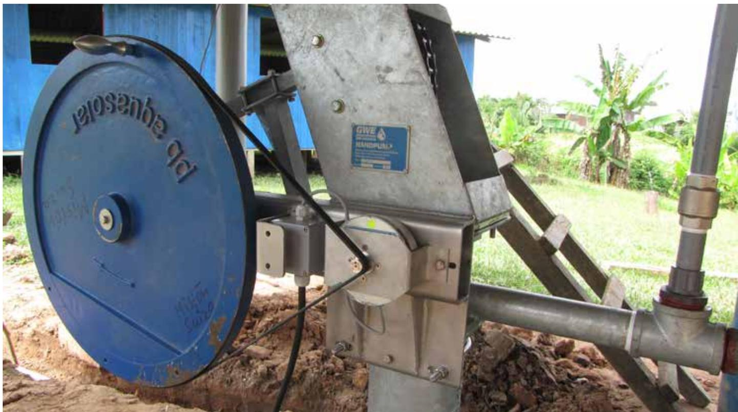
*Der Antrieb der Pumpe funktioniert mit Solarstrom. Wenn der Solarstrom fehlt, kann die Pumpe von Hand, mit dem Hebel auf der anderen Seite des Schwungrades, betätigt werden.*
