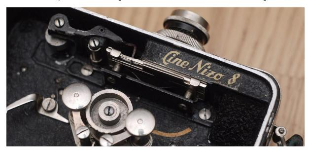
Das Bodengewinde befindet sich in der vorderen Hälfte der Gehäuselänge. Da sind das Gewinde UN %"-32 für ein Objektiv, ein Newton-Sucher mit drei Einblicken sowie einzeln schwenkbare Führungen an der kombiniert genutzten Filmwickelzahnrolle.
