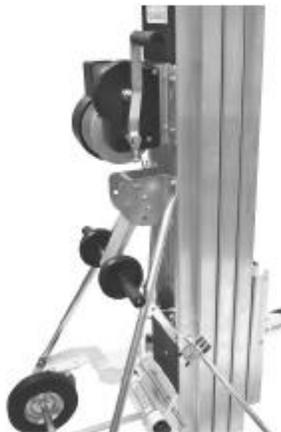
Use el guinche para subir o bajar las horquillas hasta la posición deseada. Luego, coloque las manijas del guinche hacia arriba y gírelas  $\frac{1}{4}$  de vuelta para activar el freno de seguridad.
