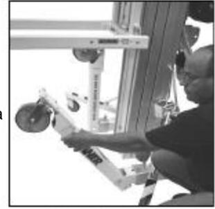
Baje la pata hasta que quede nivelada con el piso. Deslice la traba de la pata hacia adelante hasta que el pasador se enganche en su lugar. Repítalo con la otra pata.
