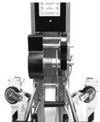
Para colocar la manija del guinche en posición de operación, tire de la traba pasante hacia arriba y deslice la manija hacia afuera del eje del guinche. Gire el ensamble de la manija de manera que el mango de plástico negro quede del otro lado del guinche. Tirando de la traba hacia arriba, deslice la manija hacia el eje del guinche.
