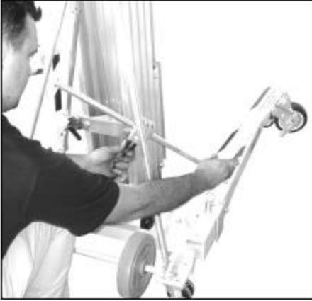
Para volver a guardar la pata, libere la traba y pliegue la pata hacia arriba.
