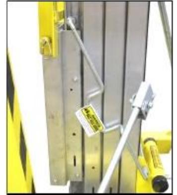
Para liberar la sujeción, tire de la barra hacia usted y colóquela detrás de las secciones del mástil.
