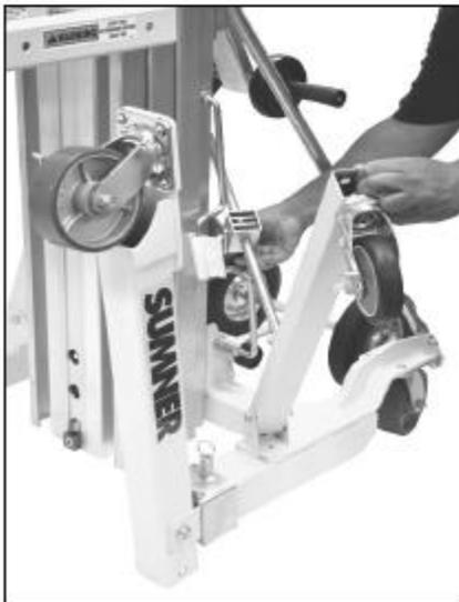
Sosteniendo una de las patas, tire del pasador de enganche y deslice la traba de la pata hacia atrás hasta el tope.
