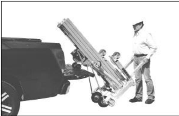
**IMPORTANTE** Antes de inclinar la unidad, se debe bajar por completo el carro y se debe colocar la Traba de Seguridad del Carro.
