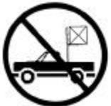
Cuando la unidad tiene una carga elevada, puede ser transportada solo sobre las ruedas de 6" de la unidad. No la opere desde una plataforma inestable, como la caja de una camioneta.
