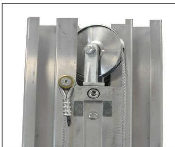
Barra de retención del mástil para el transporte horizontal. La barra de retención puede repararse si se dobla.
