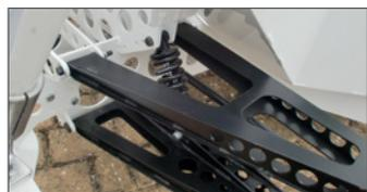
**Suspensión independiente a las 4 ruedas y regulable en altura.** Trapecios paralelos delanteros. Y horquillas traseras independientes.
