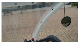
**Policarbonato de seguridad con filtro UV.** Reduce la radiación solar y protege ante impactos, anti astillado.
