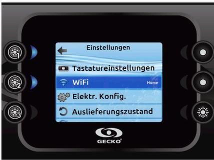
Das WiFi-Menü erscheint nur im Einstellungsmenü, wenn der in.touch über die Software-Version 11.00 oder höher verfügt. Mit diesem Menü können Sie Verbindung zu einem WiFi-Netzwerk aufnehmen oder das Netzwerk ändern.
