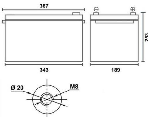
Anschluss: M8 Schraube oder M8 Poladapter
