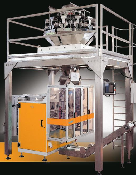
MV06-Rappresenta la soluzione ideale per pesare, dosare e confezionare in automatico prodotti in pezzi, in polvere e granulari.
