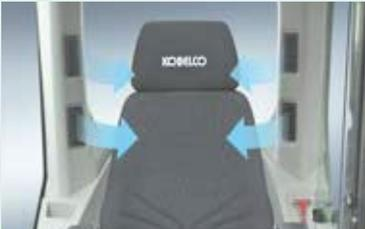
Die große Klimaanlage verfügt über Lüftungsgitter an den hinteren Säulen, die für eine Belüftung von hinten sowie rechts und links neben dem Fahrersitz sorgen. Sie können so eingestellt werden, dass sie einen Kalt-/Warmluftstrom direkt zum Fahrer leiten, was für eine bequemere Arbeitsumgebung sorgt.
