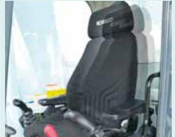
Doppel-Führungsschienen ermöglichen die Einstellung für optimalen Komfort
