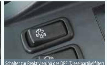
Schalter zur Reaktivierung des DPF (Dieselpartikelfilter)
