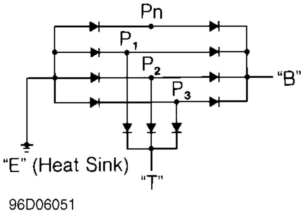
**Fig. 3: Rectifier Schematic**
