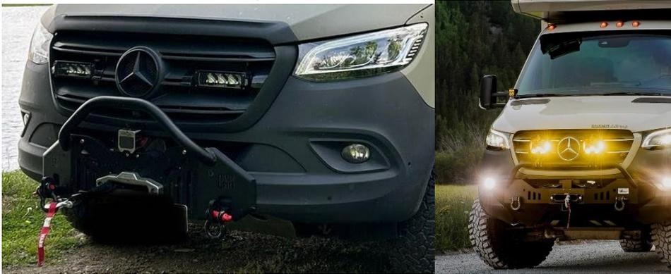
Windenträger aus hochfestem Stahl am Fahrzeugrahmen befestigt
