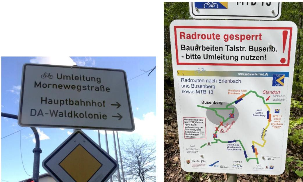
**Abbildung 46:** Umleitung für den Radverkehr während einer Baumaßnahme (links: Darmstadt Alltagsverkehr, rechts: Busenberg Freizeitroute (Foto R+T))
