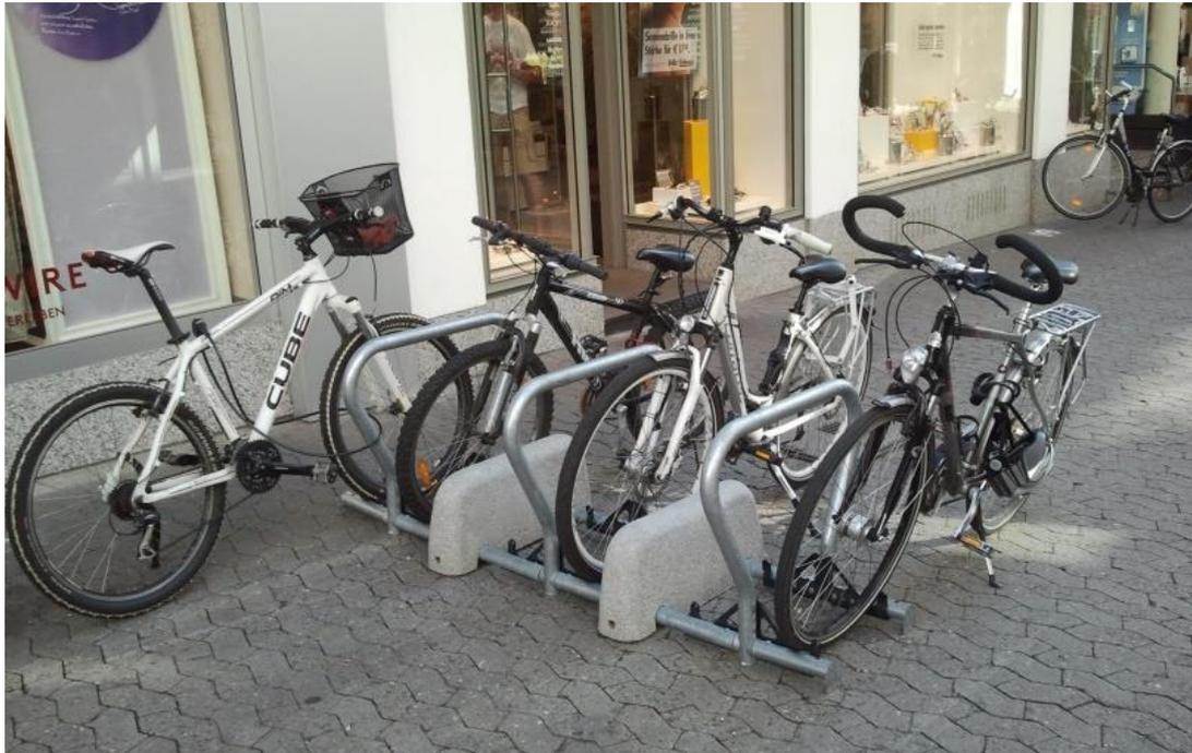
**Abbildung 3: Mobile Radabstellanlagen, welche die Mindestanforderung an Standsicherheit und Diebstahlschutz erfüllen [Foto: R+T]**
