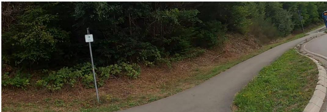
**Abbildung 34: Beispiel einer zu schmalen Radverkehrsanlage ohne Freigabe an der L 497 bei Rodalben (Foto: R+T)**
