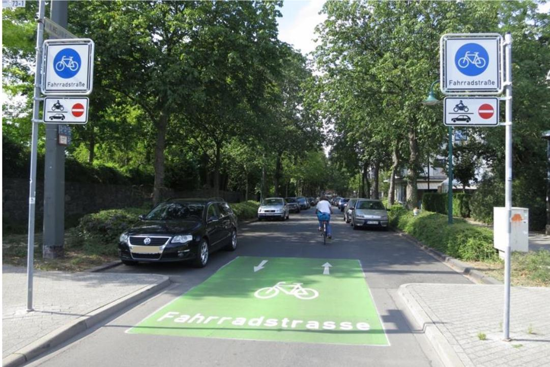
Abbildung 39: Fahrradstraße mit Einbahnregelung für den Kfz-Verkehr (Foto: R+T)
