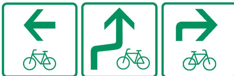
Abbildung 54: Beispiele Zwischenwegweiser
