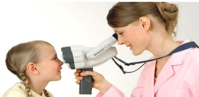
Figura 25. Refractómetro Automático Portátil
