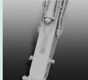
Separate Hydraulikleitung für einen Schnellwechsler, mit dem Anbaugeräte schnell gewechselt werden können.
