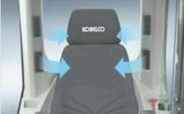
Die große Klimaanlage verfügt über Lüftungsauslässe an den hinteren Säulen, die für eine Belüftung von hinten sowie rechts und links neben dem Fahrersitz sorgen. Sie können so eingestellt werden, dass sie einen Kalt-/Warmluftstrom direkt zum Fahrer leiten, was für eine bequemere Arbeitsumgebung sorgt
