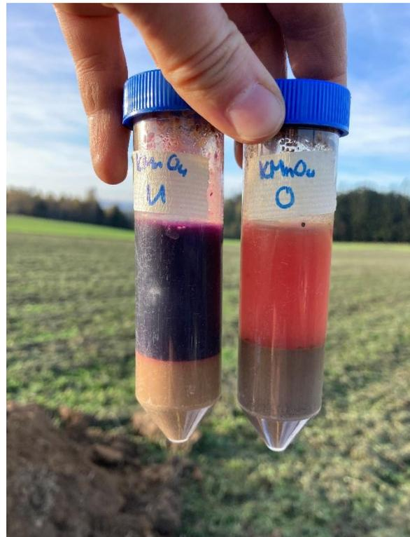
Abbildung 2 Der Slake Test (links) ist der Spatenprobe folgend eine leicht durchführbare Methode zur Bestimmung der Aggregatstabilität und Aggregatgrößenverteilung. Labiler Kohlenstoff kann über Oxidation mit 20 mM Kaliumpermanganat in 100 mM Kalziumchlorid (rechts) bestimmt werden.
