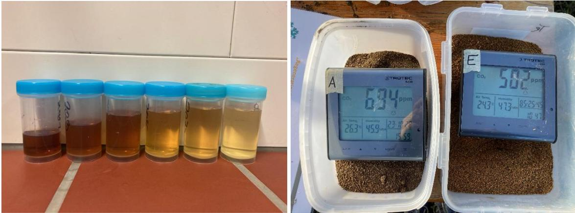
Abbildung 1 Extrakte mit 1 M NaOH nehmen proportional mit der Konzentration an stabilen Kohlenstoff an Intensität zu (links) und können fotografisch über Farbintensität und im Labor photometrisch über Absorption ausgewertet werden. Die Bodenatmung (rechts) kann im Feld mit CO<sub>2</sub>-Sensoren oder im Labor am Gaschromatographen bestimmt werden.
