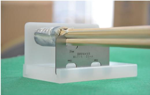
(5) ②に弦を斜め上に向けて載せ、ちくとう部直径値（対角方向）を計測する。
