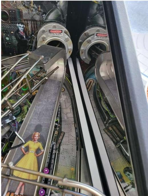
Die beiden Leuchteinheiten von hinten auf die Seitenschienen setzen.
