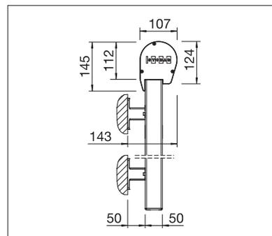
VS4300 Wandmontage mit rundem Kasten und Führungsprofil
