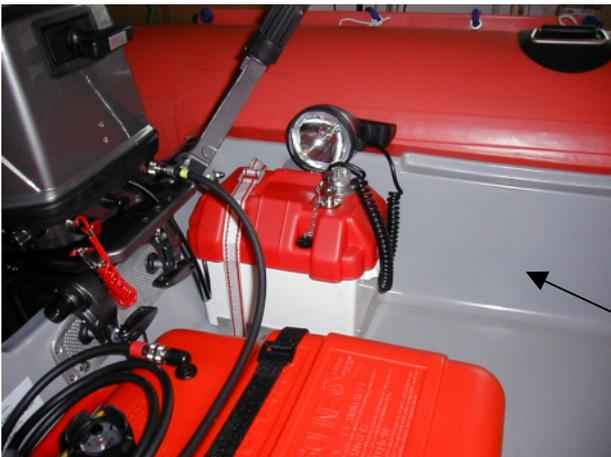
Die Befestigung einer Batterie mit Kasten,
