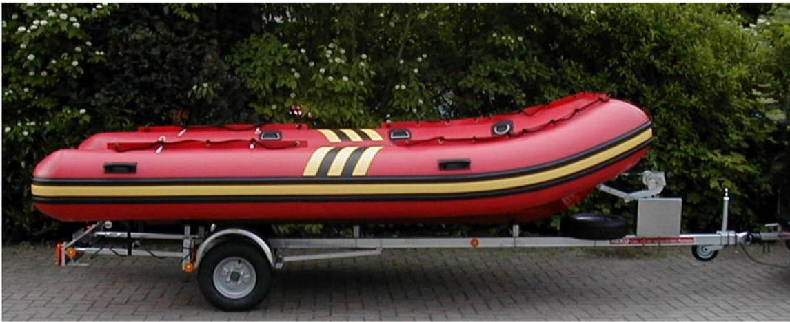
RTB 1 mit glasfaserverstärktem, doppelwandigem, unsinkbarem Kunststoffumpf. Großer integrierter Stauraum im Bug. Heckbrett für Normalschaft Außenbordmotor mit Motorsicherungsplatte Lenzventil und Spiegelschutz. 2 x umlaufenden Scheuerschutz untereinander an den Tragschläuchen sowie Taucherschutz. **4** separate Luftkammern mit Süllrand inkl. Halteleinen. Ösen für das Kranen. Mehrere Tragegriffe, eine Edelstahlschleppöse am Bug und zwei Schleppösen am Heck.
