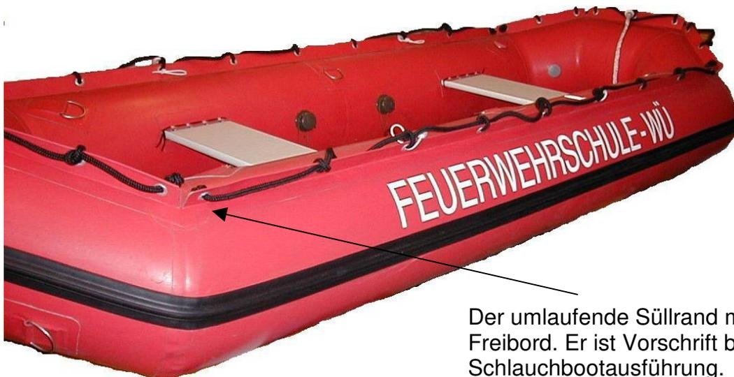
Der umlaufende Süllrand mit Halteleine erhöht den Freibord. Er ist Vorschrift bei RTB 2 in Schlauchbootausführung.
