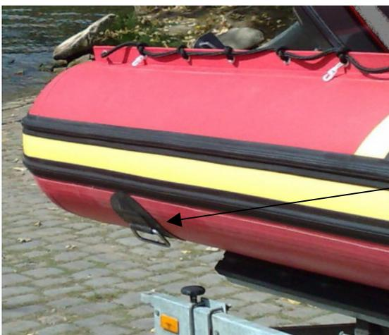
Klappbare Tragegriffe im Heckbereich erlauben das Rettungsboot auch **mit Motor** zu tragen.
