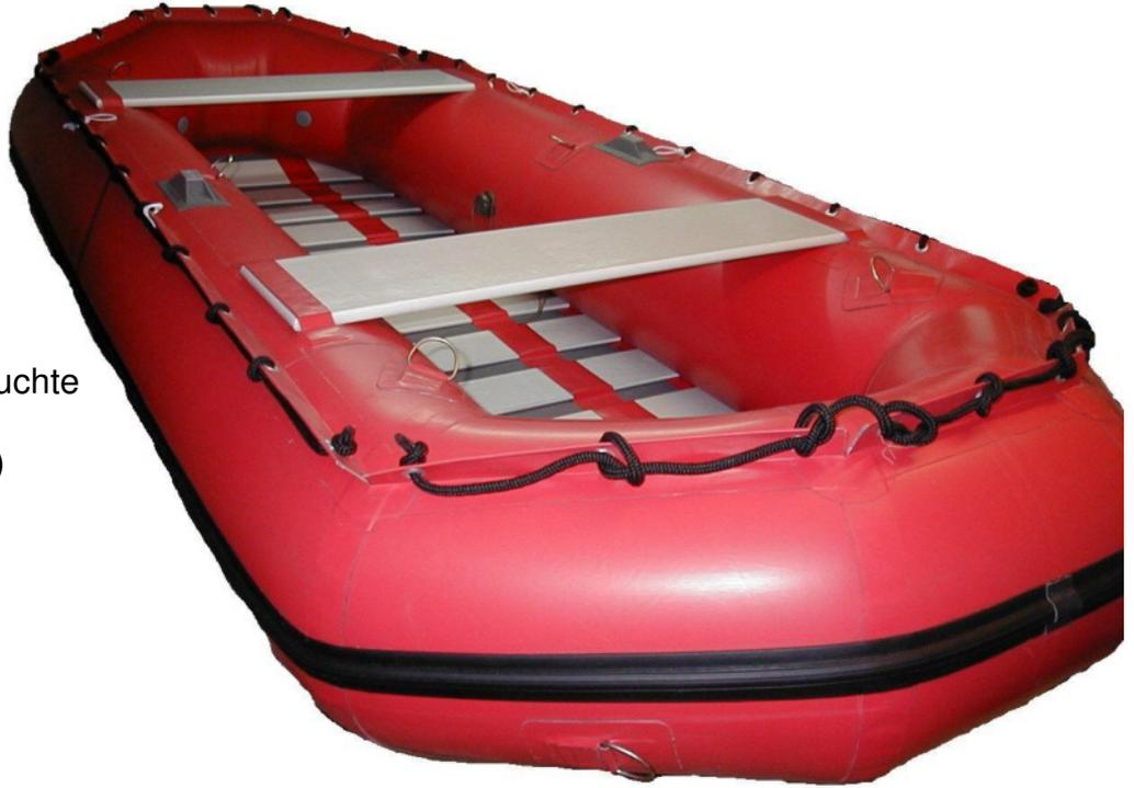
Für die Befüllung mit Pressluft beträgt die Aufrüstzeit durch eine Person gemäß DIN EN 1914:2016-12 max. 60 Sekunden.
